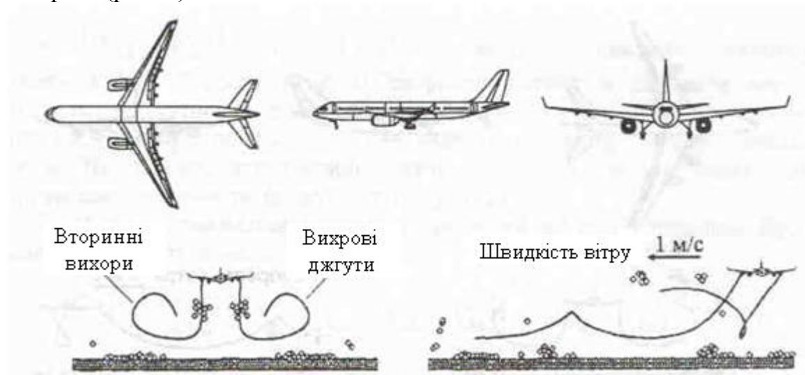
Рис. 1. Складний рух повітря при злеті крупнотонажних літаків
